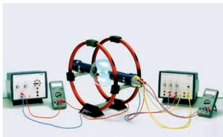
Elektronen werden im elektrischen Feld im Fadenstrahlrohr beschleunigt und treten in ein zur Flugrichtung senkrecht homogenes magnetisches Feld eines Helmholtz-Spulenpaares ein. Aus der Beschleunigungsspannung, der magnetischen Feldstärke und dem Bahnradius der Elektronen wird die spezifische Ladung des Elektrons bestimmt.
