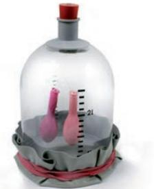
Mit Hilfe des Gummituches können die Gummiblasen in der Glocke durch herabziehen oder nach oben Drücken jeweils aufgebläht werden oder zusammenfallen.
