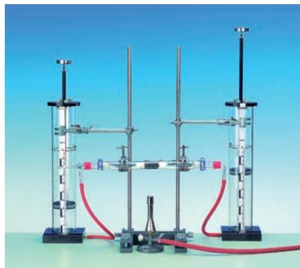
Kupfer wird in einem definierten Luftvolumen erhitzt und an der Oberfläche zu Kupfer(II)oxid oxidiert. Das Luftvolumen verringert sich durch die Reaktion um den Anteil an Sauerstoff, der in der Luft enthalten ist: Nur etwa ein Fünftel des Gasgemisches Luft reagiert mit Kupfer. Das Restgas reagiert nicht mit Kupfer. Es besteht fast ausschließlich aus Stickstoff.
