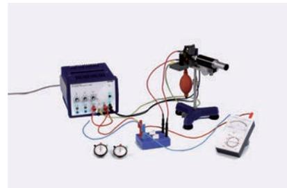
Geladene Öltröpfchen, die zwischen den Platten eines Kondensators einem elektrischen Feld und der Erdbeschleunigung unterworfen sind, werden durch Anlegen einer Spannung beschleunigt. Aus den Geschwindigkeiten in Richtung der Erdbeschleunigung und entgegengesetzt dazu wird die Elementarladung bestimmt.
