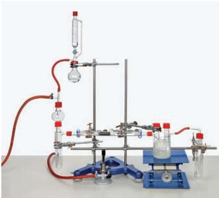
Das Kontaktverfahren wird derzeit in der chemischen Industrie zur Herstellung von Schwefelsäure in hohen Konzentrationen für industrielle Prozesse eingesetzt. In diesem Modellversuch werden Platin-Palladium-Aluminiumoxid-Perlen als Katalysator für die Reaktion eingesetzt.
