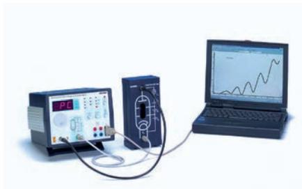
In einer mit Ne-Gas gefüllten Röhre werden Elektronen beschleunigt. Aus dem Abstand der äquidistanten Minima der Elektronenstromstärke in einem variablen elektrischen Gegenfeld wird die Anregungsenergie des Neons bestimmt.
