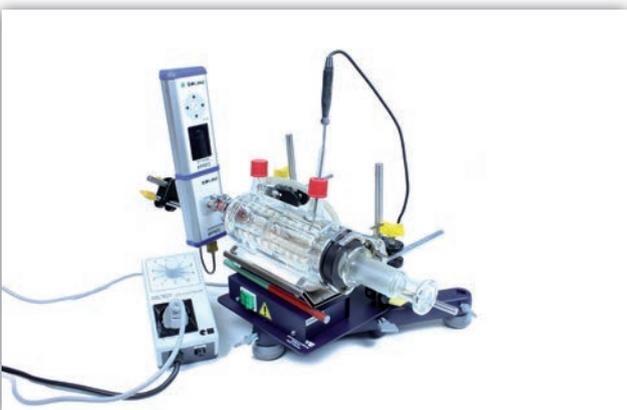
Zustandsgleichung idealer Gase mit Cobra4 (Gasgesetze: Gay-Lussac, Amontons, Boyle) (P2320162)
