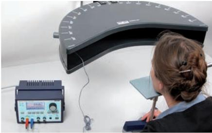
Bestimmung der Blinkfrequenz einer LED, die bloß den Eindruck eines kontinuierlichen Lichts macht. Änderung der Einfallrichtung des Lichts mithilfe eines Perimeters. Bestimmung der Blinklichtschwelle des linken und rechten Auges im Verhältnis zur Einfallrichtung des Lichtreizes und dem Anpassungszustand der Augen.
