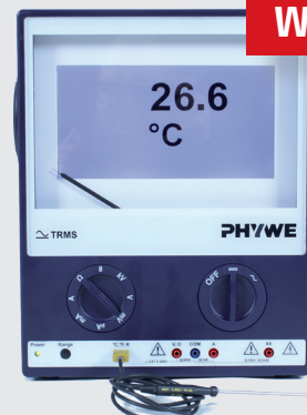
ADM 3 Vorderseite mit angeschlossenem Temperaturfühler
