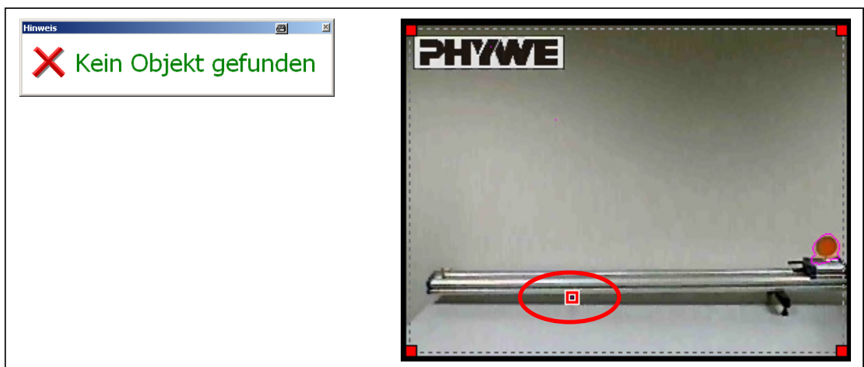
Abb. 19: Automatische Analyse: der Algorithmus zur Voruntersuchung hat an dieser Stelle (!) kein bewegtes Objekt erkannt.
