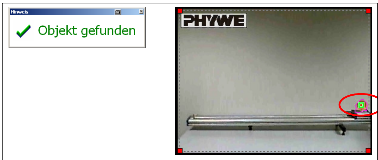
Abb. 18: Automatische Analyse: der Algorithmus zur Voruntersuchung hat an dieser Stelle ein bewegtes Objekt erkannt.
