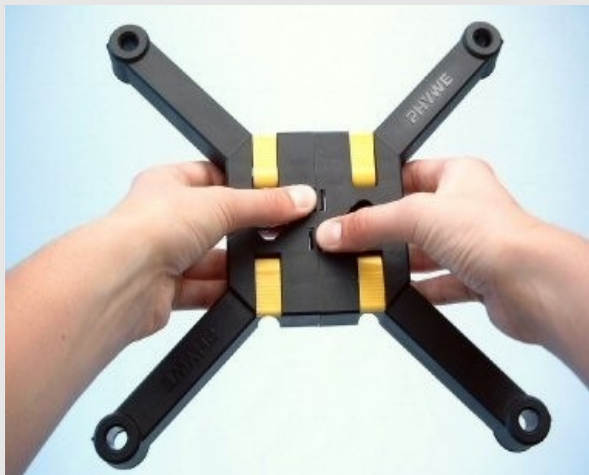
Demontage van de statiefvoet
