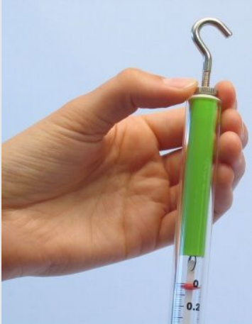
Регулювання динамометра на нульове положення
