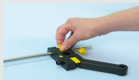
Fijar la barra de soporte
