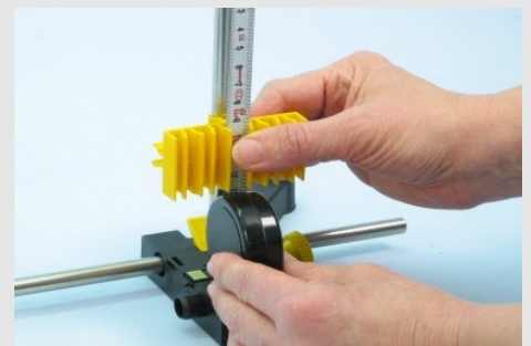
Soporte para tubos de vidrio en el trípode
