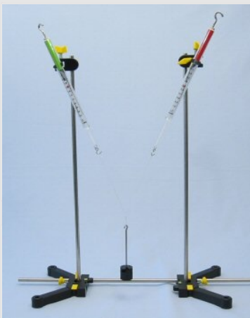
Carga los medidores de fuerza alineados con el plato de peso.
