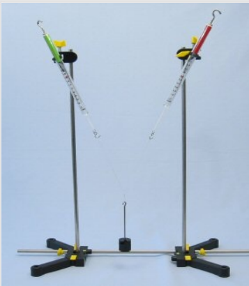
Montage de l'expérience en vue d'une détermination du parallélogramme de forces
