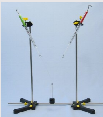
Күштердің параллелограммасын анықтауға арналған сынақ қондырғысы
