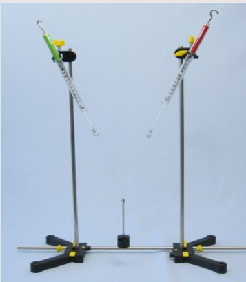
Proefopstelling voor het bepalen van het parallelogram van krachten
