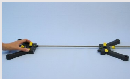
Aansluiten van de statiefdelen
