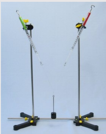
Krachtmeters met uitgelijnde belasting en halterschijf
