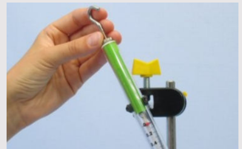
Inbrengen en afstellen van de krachtmeter
