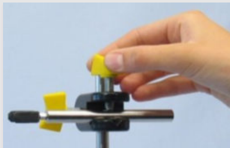
Крепление опорных стержней к двойной розетке
