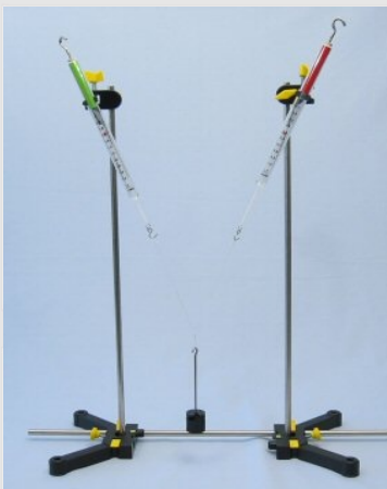
Нагрузить выровненные манометры с весовым диском
