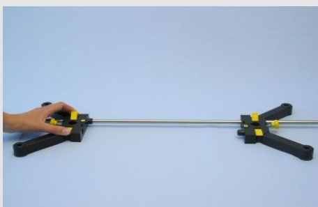
Conectando los pies del trípode
