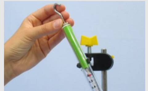
Insertar y ajustar los medidores de fuerza
