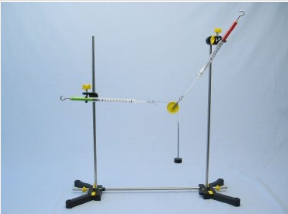
Configuración de prueba para determinar la fuerza resultante en el rodillo de desviación
