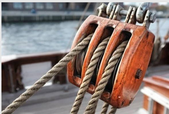
Желкенді яхтаның блоктары (шкивтері)
