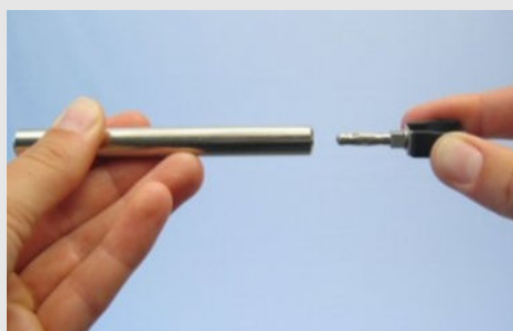
Манометр ұстағышын штативті штангаға салыңыз
