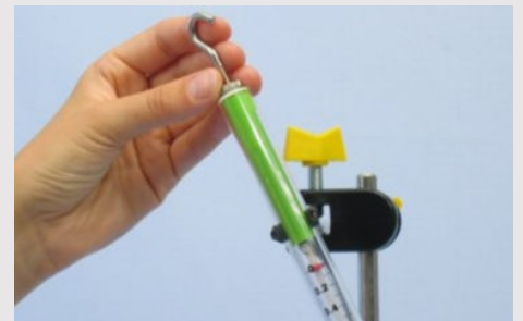
Inbrengen en afstellen van de krachtmeters
