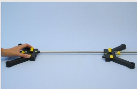
З'єднання основи штатива з довгим штативним стрижнем
