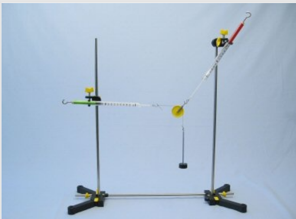
Експериментальна установка для визначення результуючої сили на блоці
