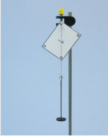
El procedimiento de plomada en el cuerpo regular
