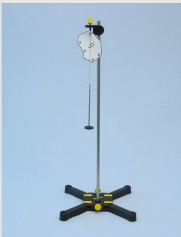
Método para determinar el centro de gravedad
