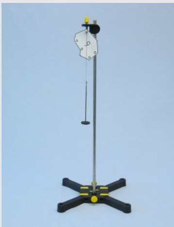
Loodlijnmethode voor het bepalen van het zwaartepunt
