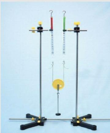
Prueba de configuración para determinar la fuerza en un rodillo suelto
