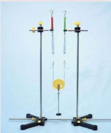
Montage d'expérience pour déterminer la force exercée sur une poulie mobile
