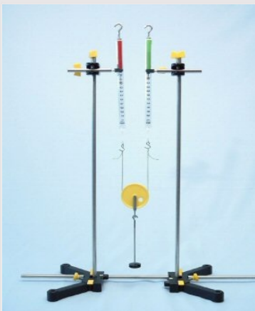
Proefopstelling voor het bepalen van de kracht op een losse rol
