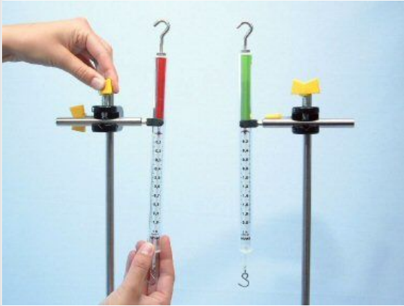
Прикріплення та регулювання динамометра
