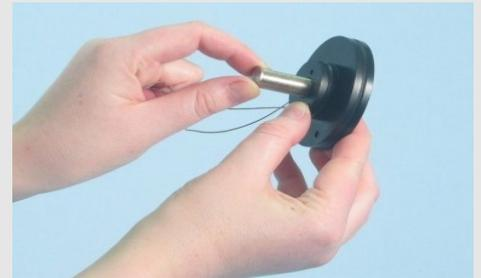
Montar el eje en la polea
