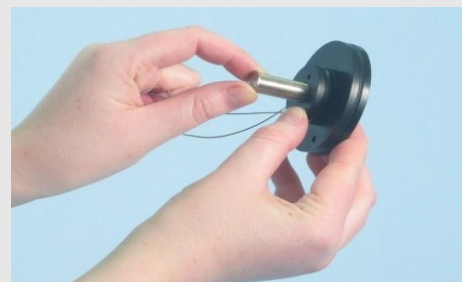
Установить вал в ступенчатое колесо
