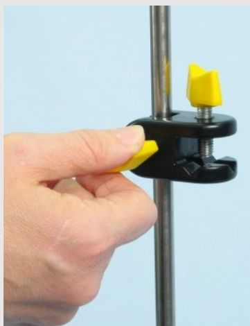
Монтаж двойной муфты на штативном стержне
