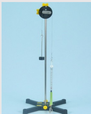
Экспериментальная установка для определения действующей силы
