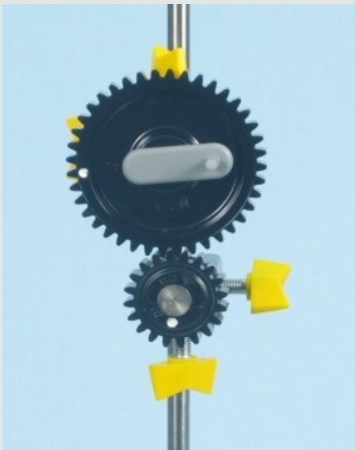
Versuchsaufbau des einstufigen Zahnradgetriebes
