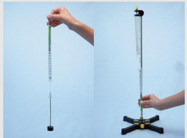
Anheben einer Masse und Dehnen einer Feder, jeweils mit Hilfe eines Kraftmessers
