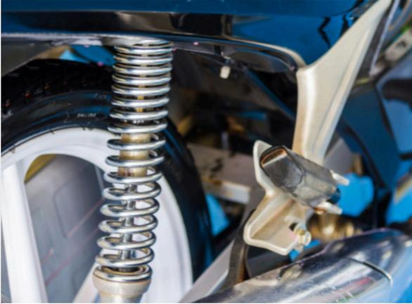
Schraubenfeder als Stoßdämpfer am Motorrad
