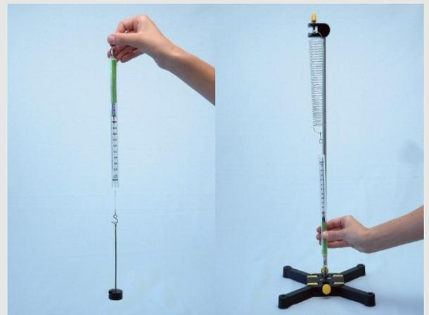
Soulever une masse et étirer un ressort, chacun à l'aide d'un dynamomètre
