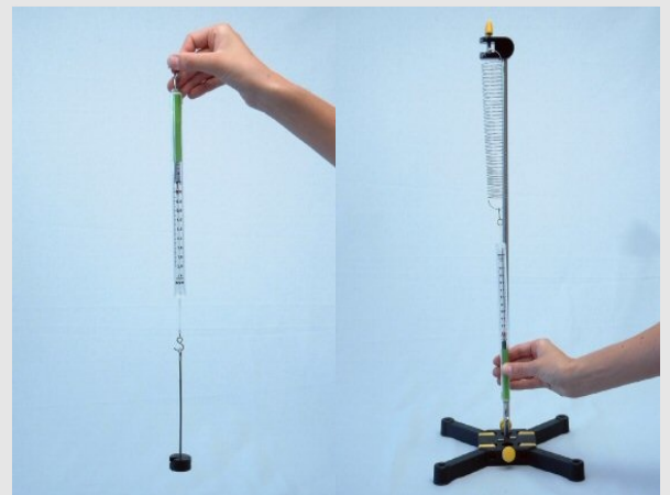
Optillen van een massa en uittrekken van een veer, elk met behulp van een krachtmeter
