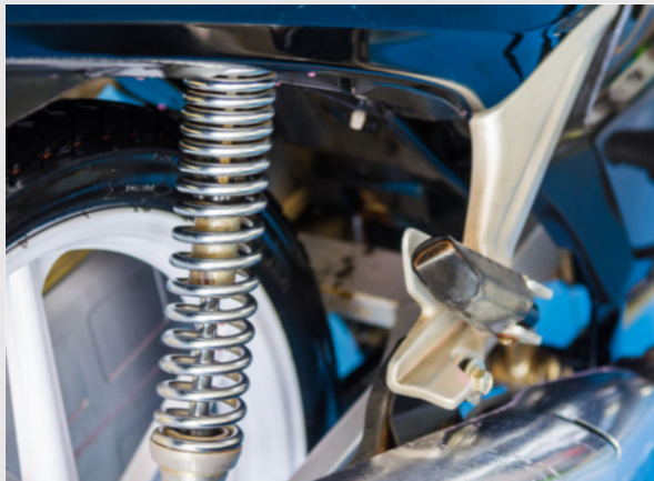
Пружина як амортизатор на мотоциклі
