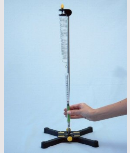
Визначення сили пружності
