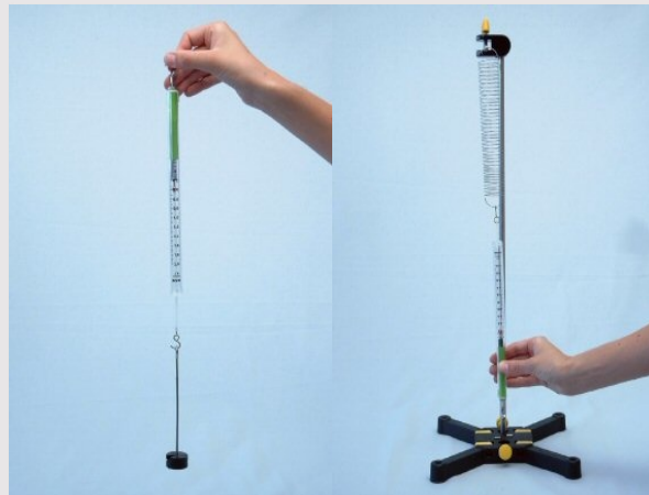
Підйом вантажу і розтягнення пружини
