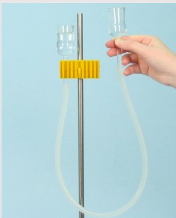
Vergelijking van de waterniveaus in de twee glazen stolpen
