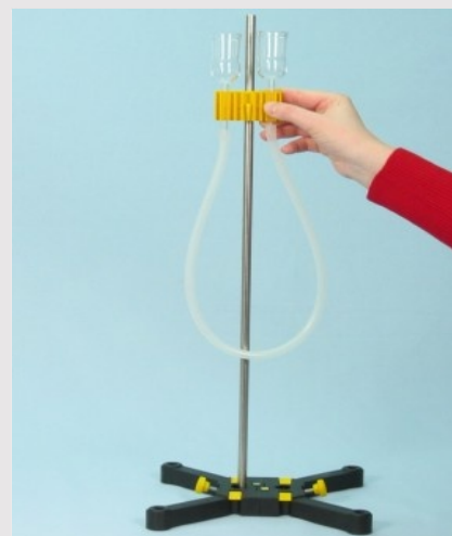
Aansluiten van de stolpen met de slang
