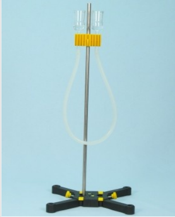
Vergelijking van de waterniveaus in de twee stolpen
