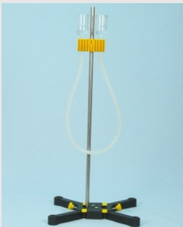
Proefopstelling van de U-buis
