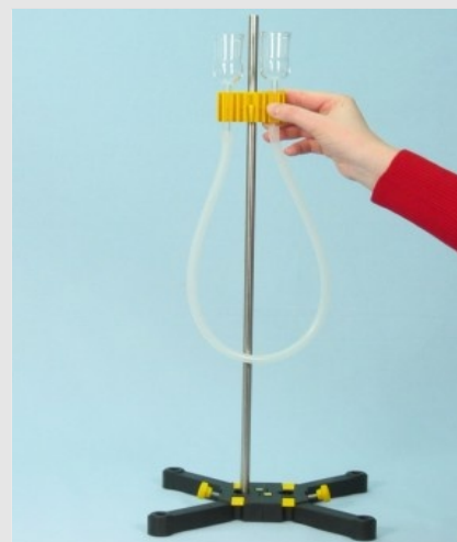
Соединение стеклянных колоколов с помощью шланга
