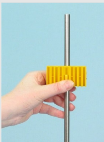
Закрепите держатель стеклянной трубки на штативном стержне.
