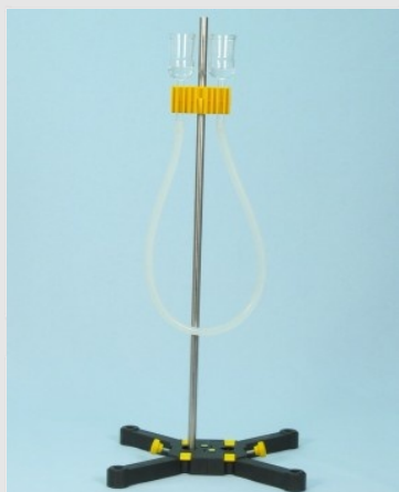
Тестовая установка U-образной трубы
