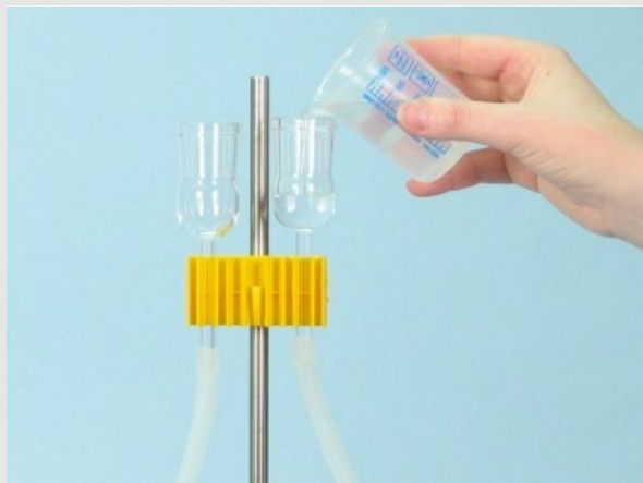
Заполнение U-образной трубки водой
