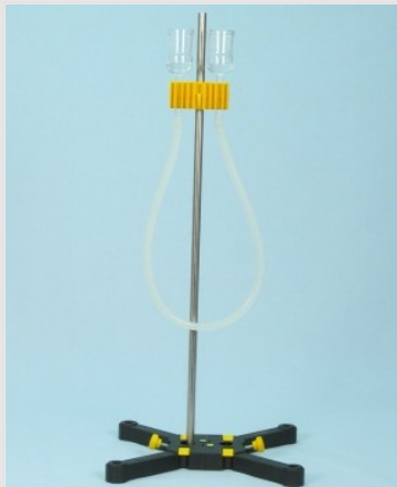
Сравнение уровня воды в эксперименте с двумя стеклянными колоколами
