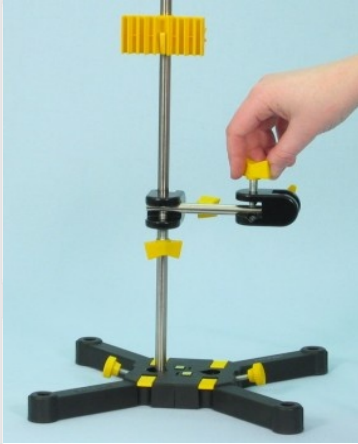
Bevestigen van de korte staaf aan de dubbele mof
