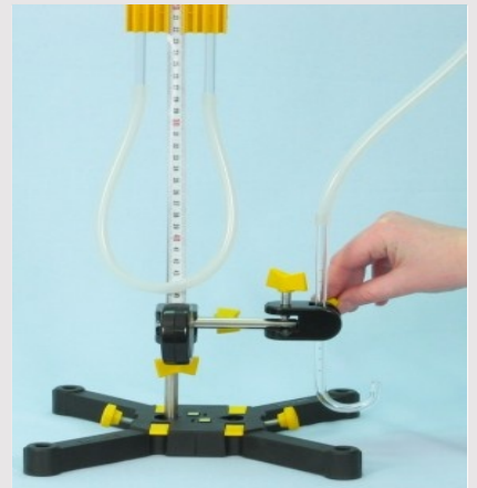
Aansluiten van de meetsonde
