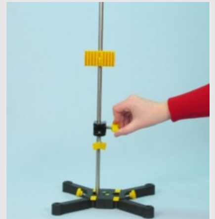
Bevestigen van de dubbele klem
