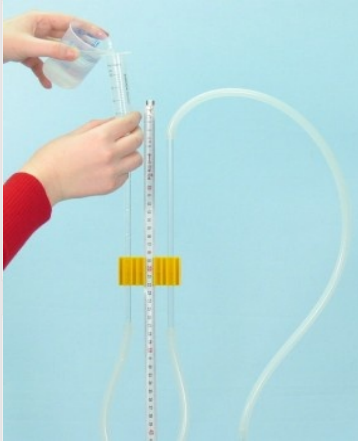
Vullen van de manometer
