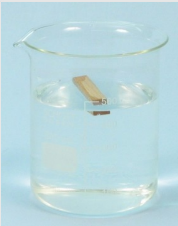
Schwimmende Holsäule in mit Wasser gefülltem Behälter
