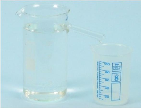
Befüllen des Überlaufgefäßes mit Wasser
