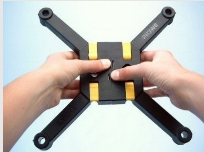
Desmontando la base del soporte
