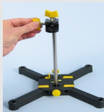
Fijando la doble nuez a la barra de soporte
