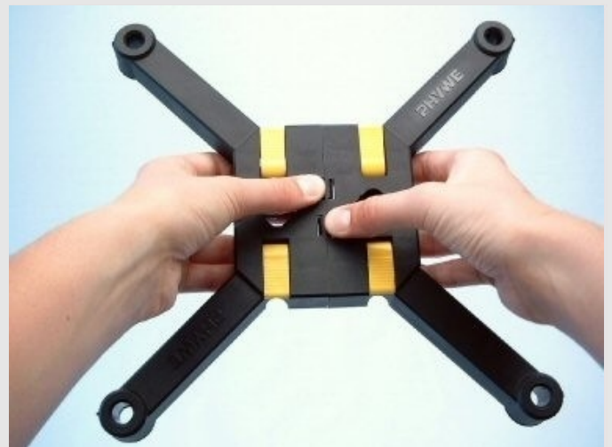
Demontage van de statiefvoet
