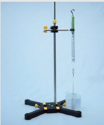
Montaje experimental para determinar la densidad de un cuerpo por medio de su fuerza de flotación
