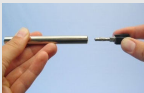
Insérer le support pour dynamomètre dans la tige de support
