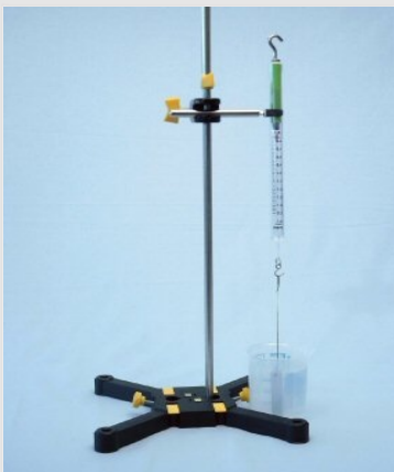
Montage d'expérience pour déterminer la densité d'un corps au moyen de sa force de poussée d'Archimède
