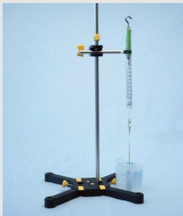
Дене тығыздығын анықтауға арналған эксперименттік қондырғы
