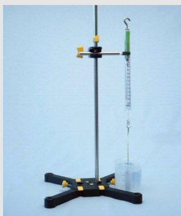
Дене тығыздығын анықтауға арналған эксперименттік қондырғы
