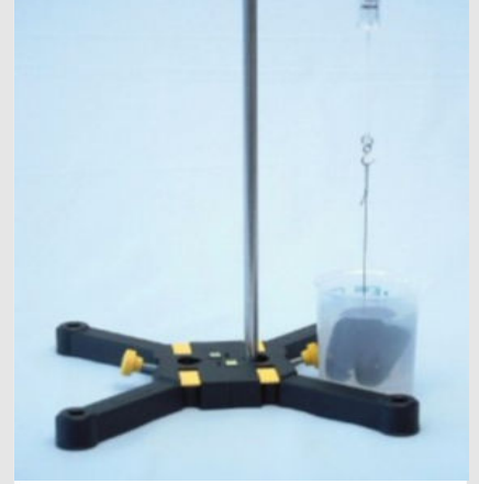
Bepaling van de gewichtskrachten in water F_{G,Water}
