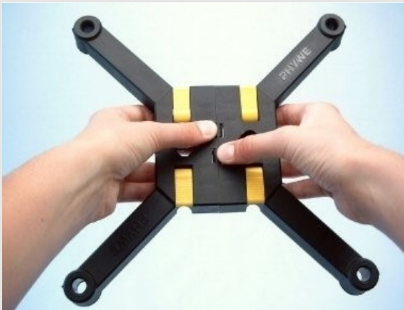
Demontage van de statiefvoet
