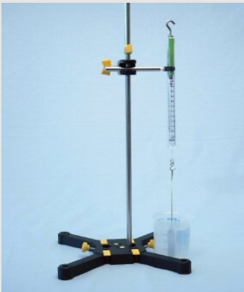
Proefopstelling voor de bepaling van de dichtheid van een lichaam met behulp van zijn archimedeskracht
