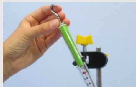
Крепление и юстировка динамометров
