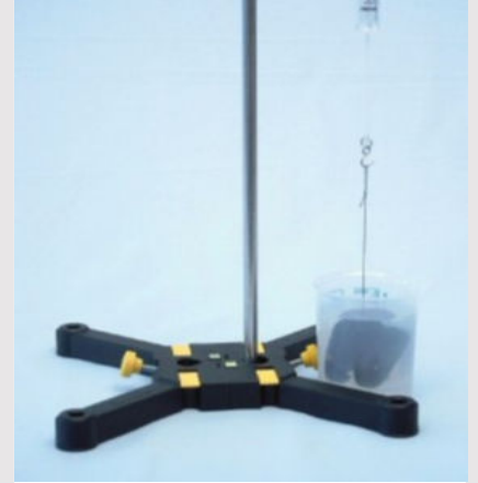
Определение веса в воде F_{G,Wasser}
