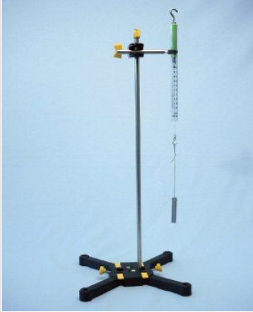
Определение веса в воздухе F_{G,Luft}
