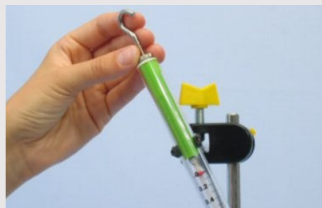
Кріплення та юстування динамометра
