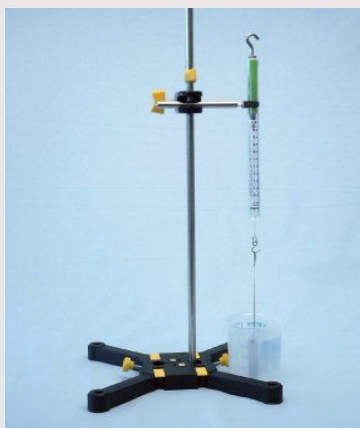
Експериментальна установка для визначення густини тіла
