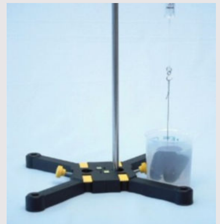
Визначення ваги тіла у воді F_{G,v}
