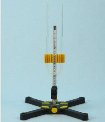
Configuración del ejercicio para determinar la densidad de los líquidos inmiscibles
