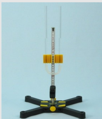
Экспериментальная установка для определения плотности
