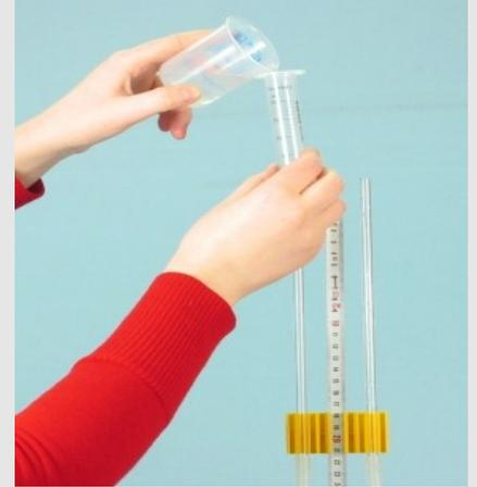
U-Rohr mit Wasser befüllen
