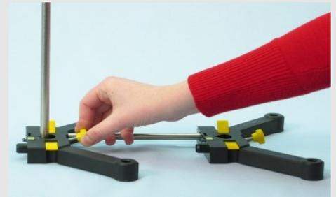
Befestigen mit Hilfe der Verschlusschraube
