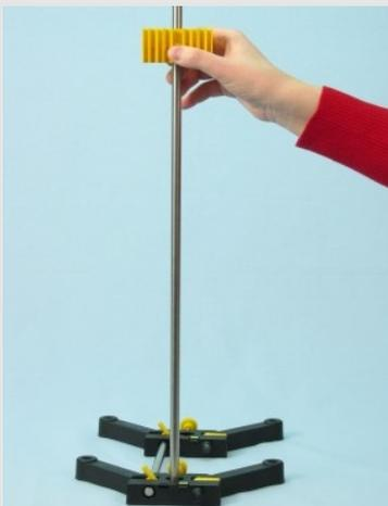
Glasrohrhalter an der Stativstange befestigen
