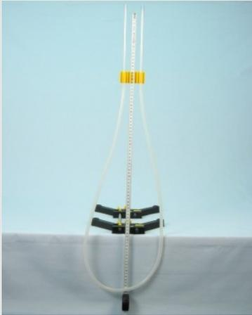
Aufbau eines U-Rohres
