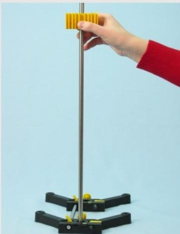
Fijar el soporte del tubo de vidrio a la barra de soporte
