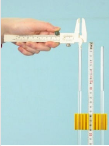
Metten van de binnendiameter d_i
