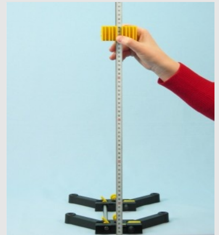
Bevestig het meetlint aan de glasbuis houder
