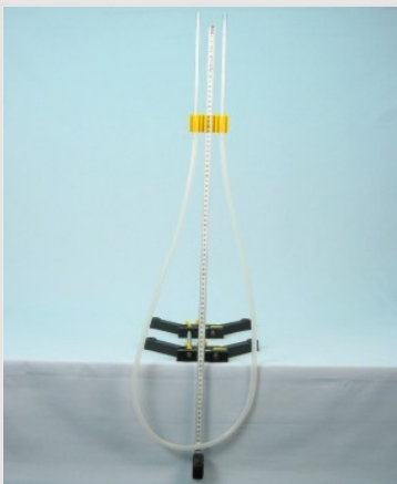
Proefopstelling voor het onderzoek van de wet van Boyle-Marriote
