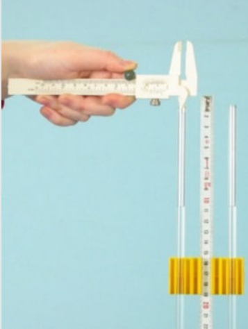
Измерение внутреннего диаметра d_i
