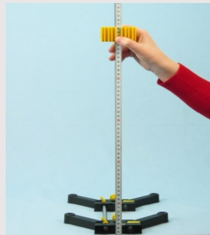
Прикрепить рулетку к держателю для стеклянной трубки
