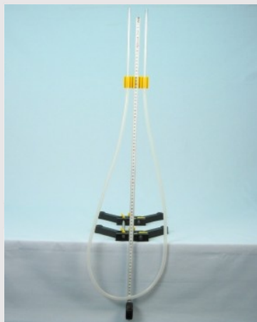
Сборка U-образной трубки
