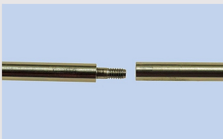
Скручивание штативных стержней
