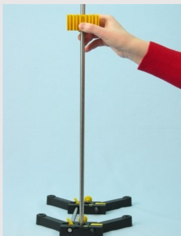
Прикрепить держатель для стеклянной трубки к штативному стержню
