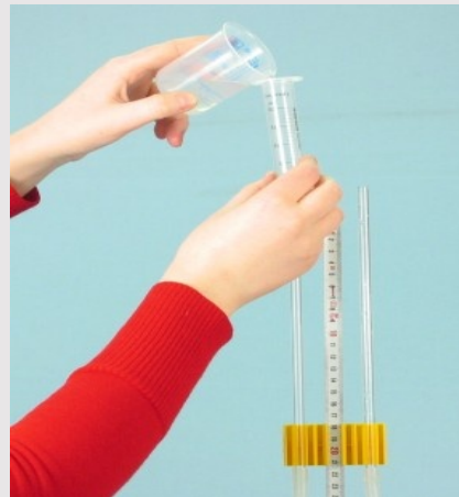
Наполнение U-образной трубки водой
