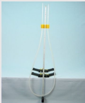
Экспериментальная установка для исследования закона Бойля-Мариотта
