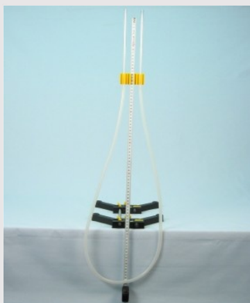
Экспериментальная установка для исследования закона Бойля-Мариотта
