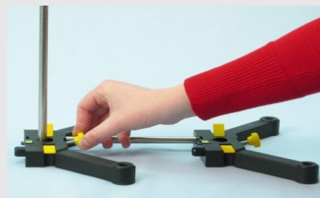
Сборка штатива и фиксация штативных стержней
