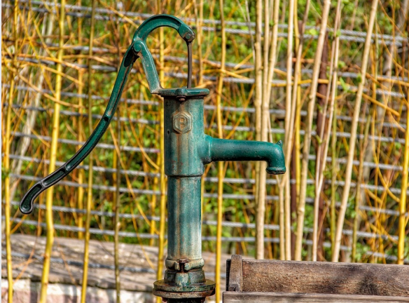
Gartenpumpe zur Förderung von Wasser aus einem Brunnen
