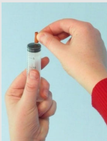
Gummischlauch über die Spritze ziehen
