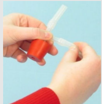
Silikonschlauch an die Enden des T-Stückes stecken
