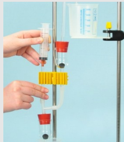
Gummischlauch in das Glasrohr stecken
