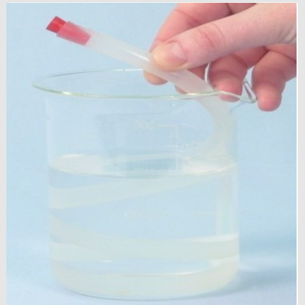
Gummistopfen in den Schlauch drücken
