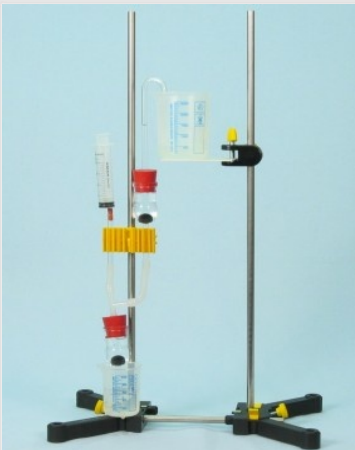
Versuchsaufbau zur Untersuchung der Wirkweise von Pumpen
