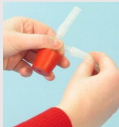
Bevestig de siliconenslang aan de uiteinden van het T-stuk.
