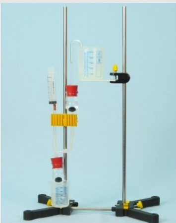
Proefopstelling voor het onderzoeken van de werking van pompen
