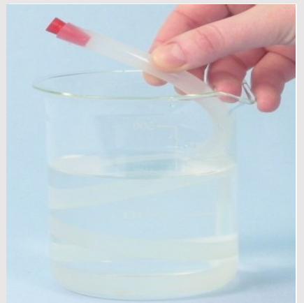
Druk de rubberen stop in de slang
