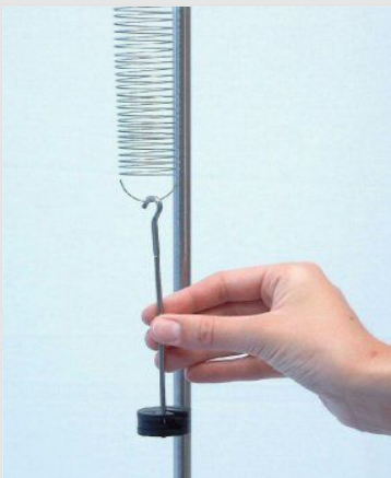
Feder mit unterschiedlichen Massen m belasten
