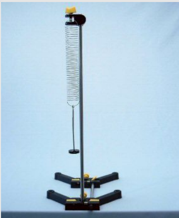
Versuchsaufbau des Schraubenfederpendels
