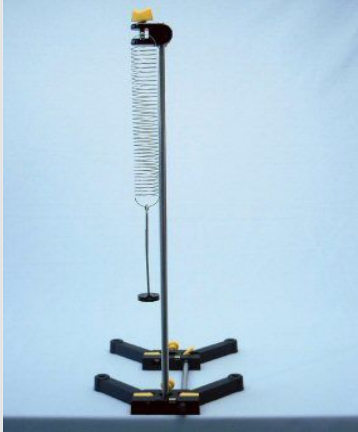
Versuchsaufbau des Schraubenfederpendels
