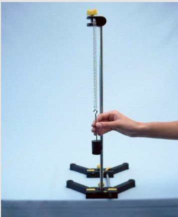
Auslenken der Feder mit der Federkonstante 20 \text{ N/m}
