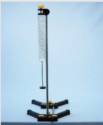
Versuchsaufbau des Schraubenfederpendels
